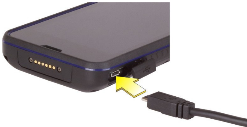
圖表 3-2：連接 Micro USB 線至 MODAT-532A
