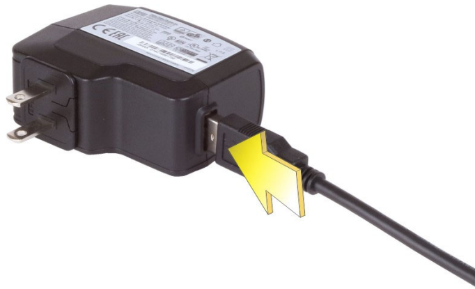
圖表 3-4：連接 MODAT-532A 至電源適配器
