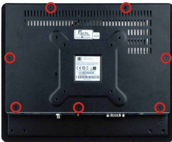
图表 3-1: PPC-F10B-BT 后盖固定螺丝
